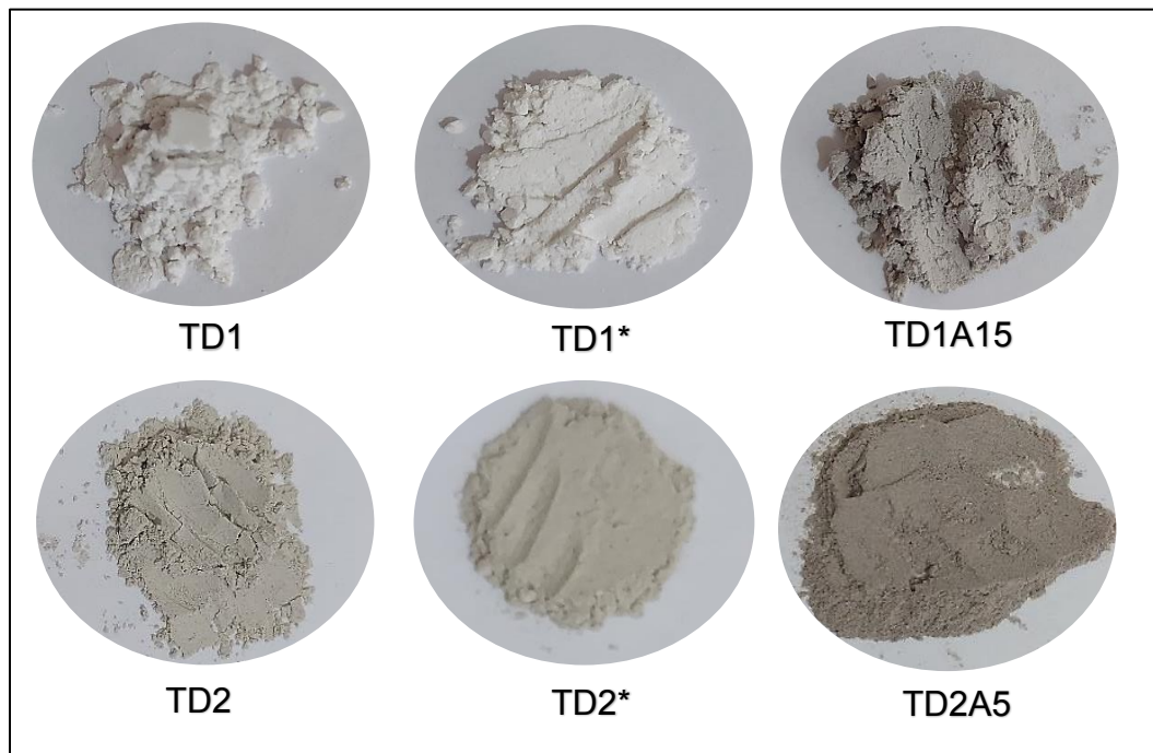
Figura 0-3 Registros fotográficos de TD1 y TD2 antes y después de la activación (TD1* y TD2*) y luego de la adsorción de iones Ag^+ (TD1A15 y TD2A5).
